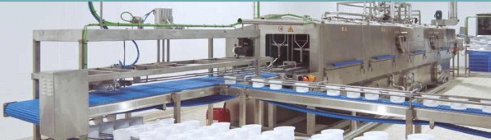
Mimasa diseña y fabrica todo tipo de túneles de lavado de moldes. Sistemas automáticos y flexibles para todos los sectores que aseguran una higienización efectiva.
